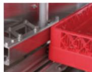
洗浄ラックがすすぎ部を通過中にのみ稼働するリンスセーバー。自動でON・OFFを繰り返す設計で、省エネに貢献します。
