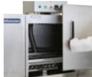
清掃、点検に便利な扉はサービス性の向上に直結。コスト削減においても重要なポイントとなります。洗浄タンクへの給湯確認に便利な中間ストップパー付です。
